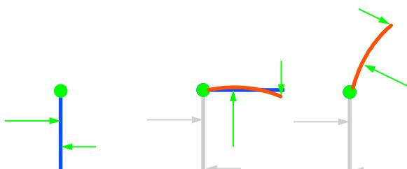
Un sistema di forze applicato ad un corpo comporta dei moti rigidi e degli spostamenti locali, dovuti alla deformabilità della struttura.
