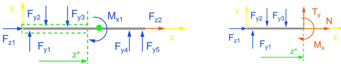
Sarà sufficiente sostituire alla parte del corpo non compresa nella linea di distacco (tratteggiata) le corrispondenti caratteristiche di sollecitazione (essendo un problema piano si avranno come caratteristiche di sollecitazione lo sforzo normale  $N$ , il taglio  $T_y$  lungo  $y$  e il momento flettente  $M_x$ ). I versi positivi di tali caratteristiche di sollecitazione sono determinati dalla ‘regola della mano destra’ ed indicati in figura.
