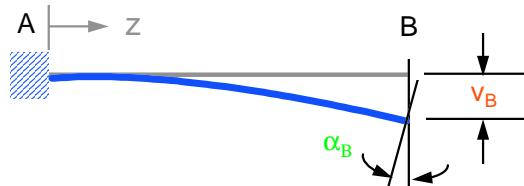
In particolare il valore della rotazione massima e della freccia massima si hanno in corrispondenza della sezione dove è applicato il carico ( $z = L$ ):
