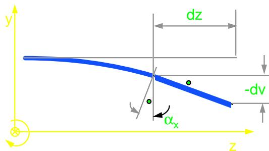
La relazione fra la freccia 'v' e la rotazione si ricava osservando la figura sopra:
