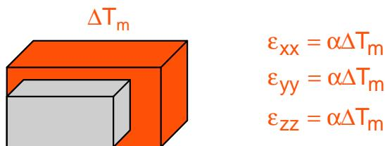
si noti che una variazione uniforme della temperatura provoca un aumento delle dimensioni ma, se il corpo è lasciato libero di dilatarsi, non sono presenti tensioni e non vi sono distorsioni.
