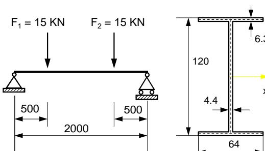
Caratteristiche della sezione:  $A = 1.32 \cdot 10^3 \text{ mm}^2$   $J_{xx} = 3.18 \cdot 10^6 \text{ mm}^4$   $J_{yy} = 2.77 \cdot 10^5 \text{ mm}^4$
