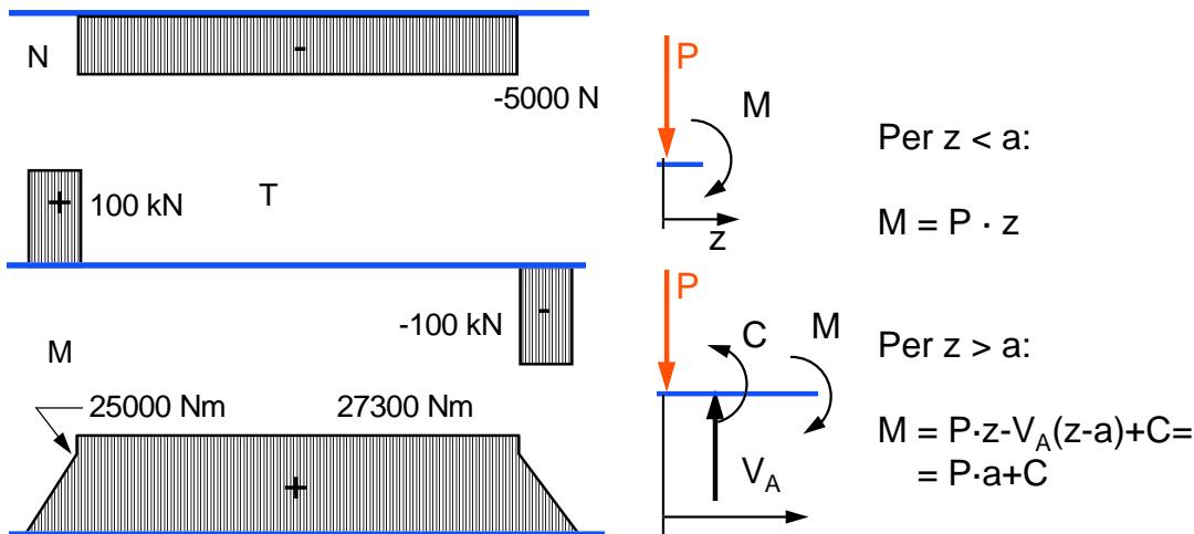
**- Tensioni nel tratto fra le due ruote dovute allo sforzo normale.**
