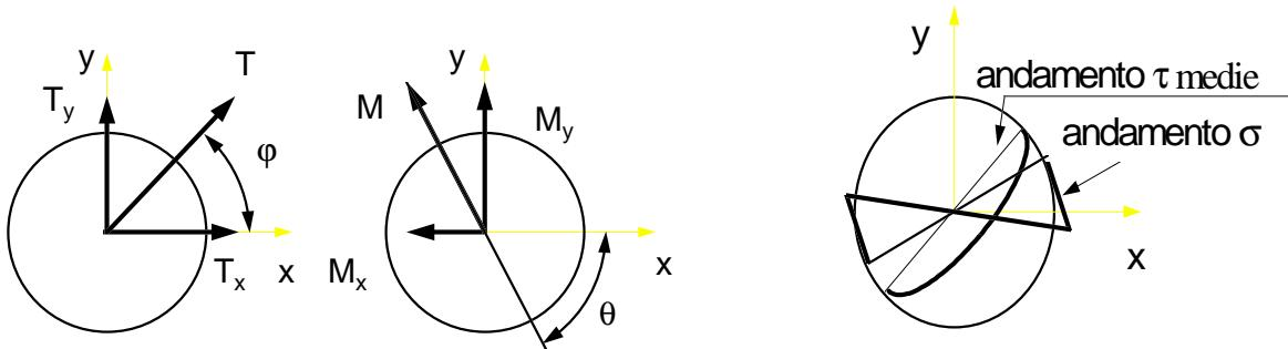
Questo fatto comporta che dove la tensione di flessione è massima (minima) la tensione dovuta al taglio non è nulla. Poiché le tensioni dovute al taglio nelle travi snelle sono comunque piccole rispetto alle tensioni di flessione, esse vengono di norma trascurate. Si noti inoltre che il valore fornito dalle formule di Jourawski forniscono solo il valore medio
